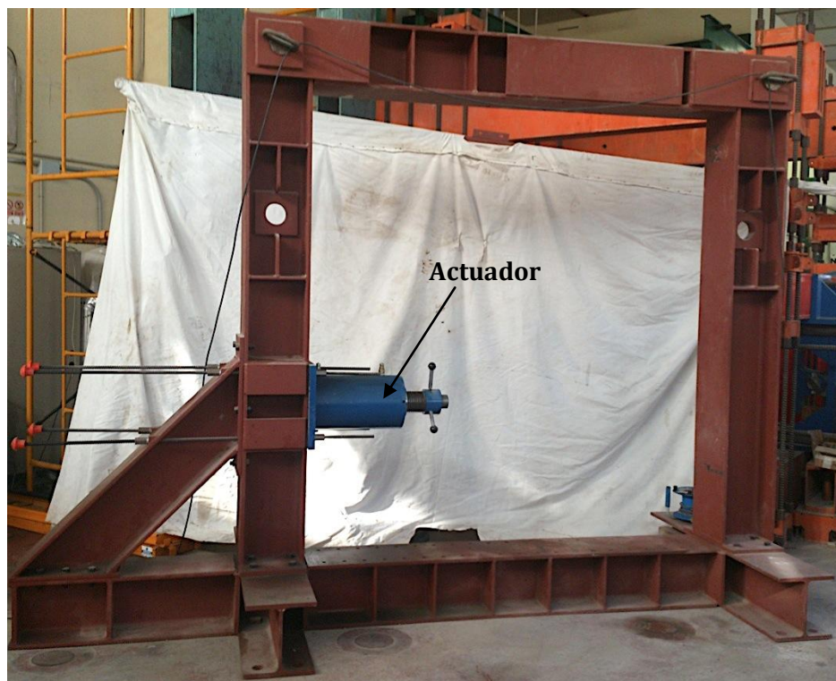
Figura 80. Montaje de la probeta en el pórtico de ensayo paso 1.
