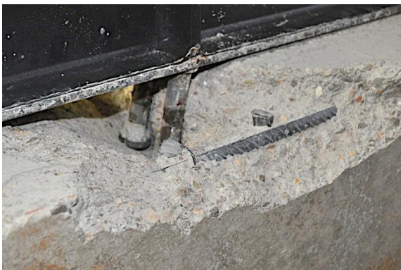
g) Detalle pernos tras rotura
