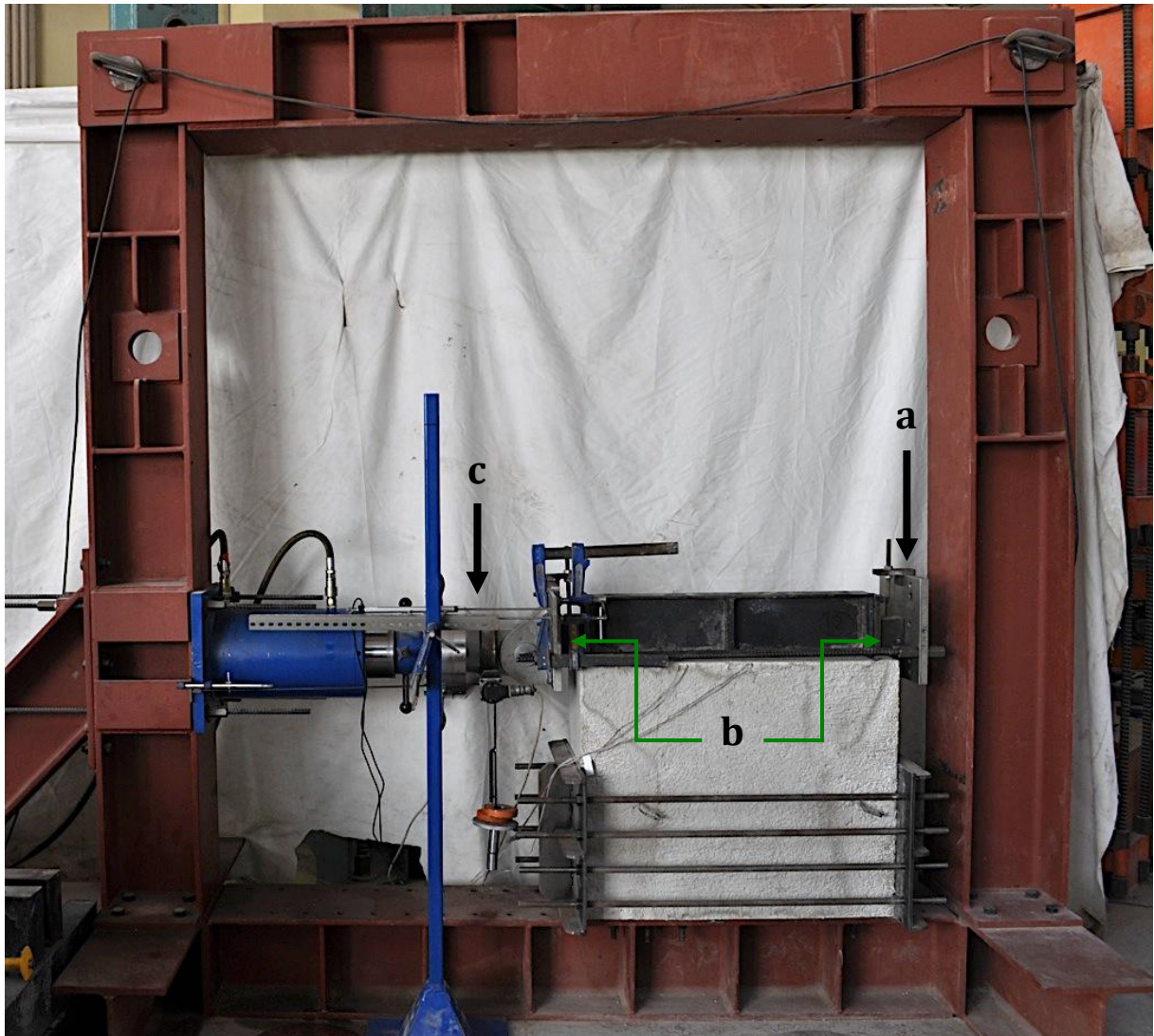
Figura 83. Montaje de la probeta en el pórtico de ensayo paso 4.
