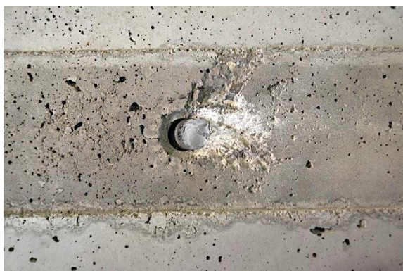
g) Detalle perno tras rotura
