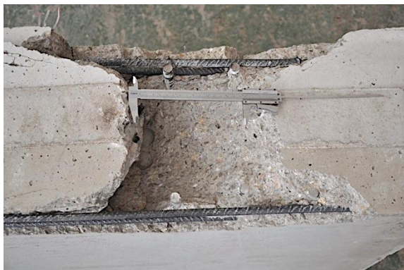
g) Detalle pernos tras rotura
