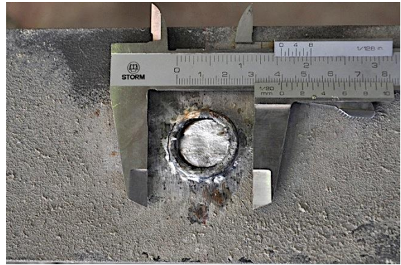
f) Detalle perno derecho tras rotura
