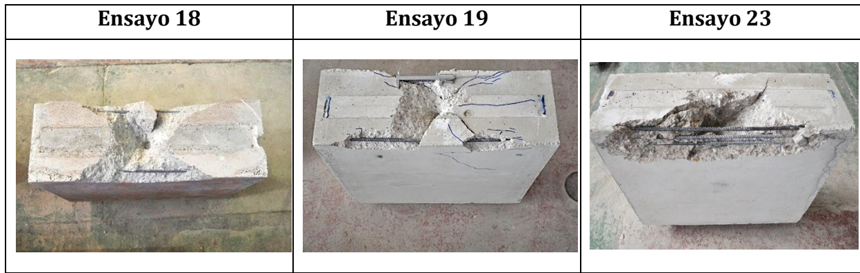
Figura 90. Roturas por pryout de los ensayos monotónicos en la disposición PI.
