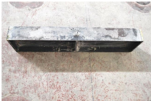
c) Detalle IPE tras rotura
