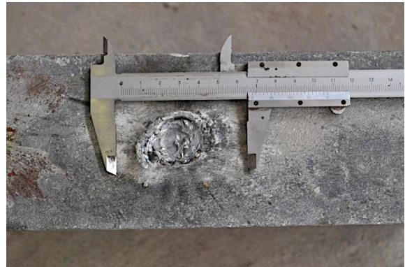
f) Detalle perno derecho tras rotura
