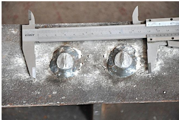
e) Detalle pernos tras rotura
