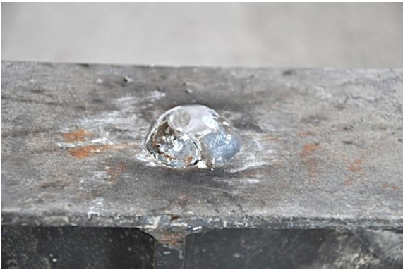
e) Detalle perno tras rotura
