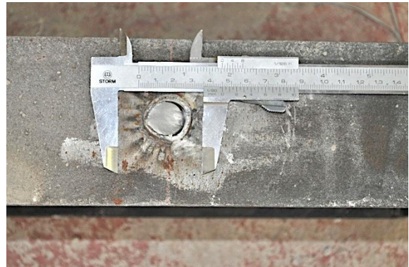
f) Detalle perno derecho tras rotura
