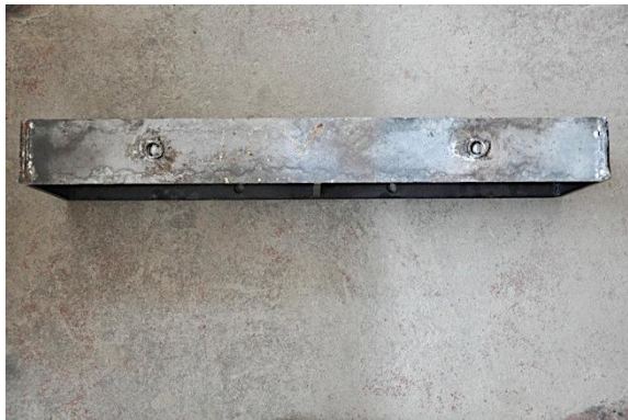
c) Detalle IPE tras rotura
