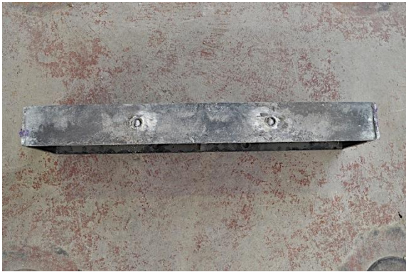
c) Detalle IPE tras rotura
