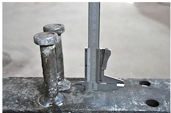
f) Detalle pernos tras rotura
