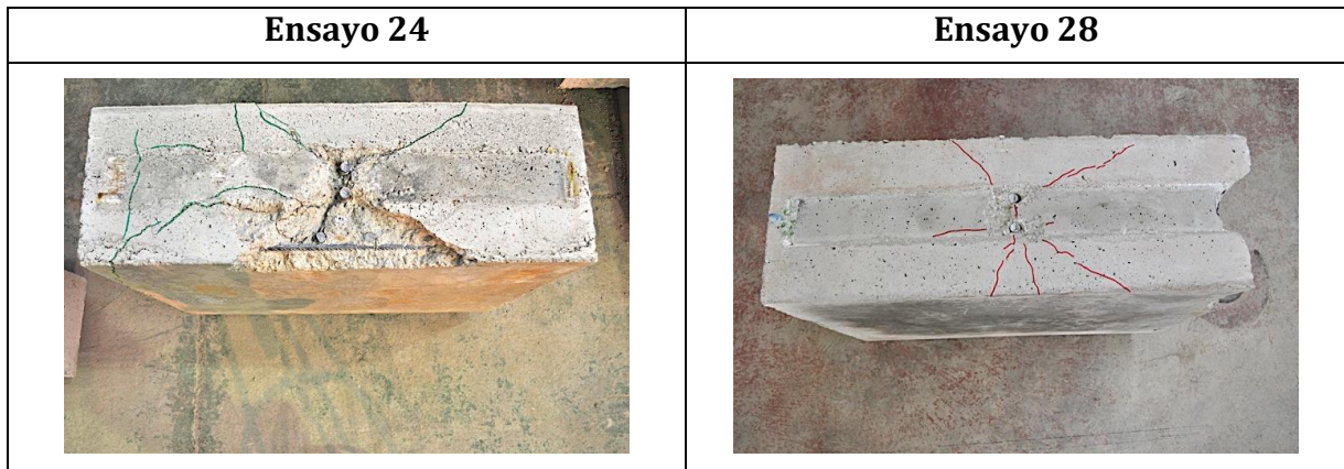
Figura 120. Roturas del acero de ensayos cíclicos en la disposición POEG.
