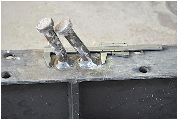
e) Detalle pernos tras rotura
