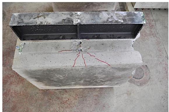
f) Alzado probeta tras rotura
