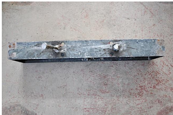
c) Detalle IPE tras rotura
