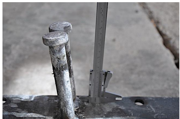
f) Detalle pernos tras rotura
