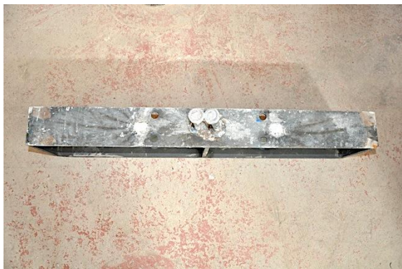
c) Detalle IPE tras rotura
