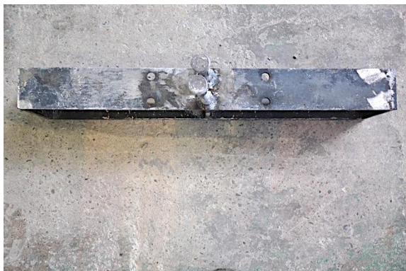
c) Detalle IPE tras rotura
