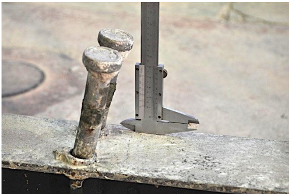
e) Detalle pernos tras rotura
