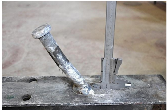
f) Detalle perno derecho tras rotura
