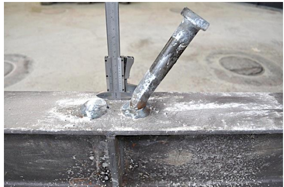
f) Detalle pernos tras rotura
