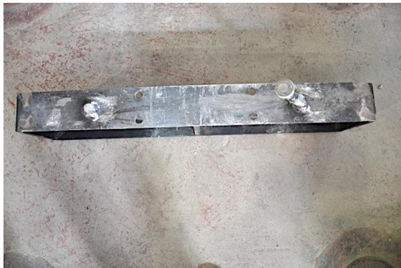
c) Detalle IPE tras rotura
