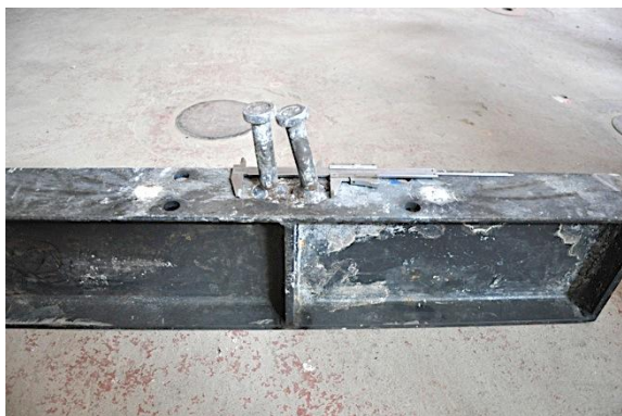
e) Detalle pernos tras rotura
