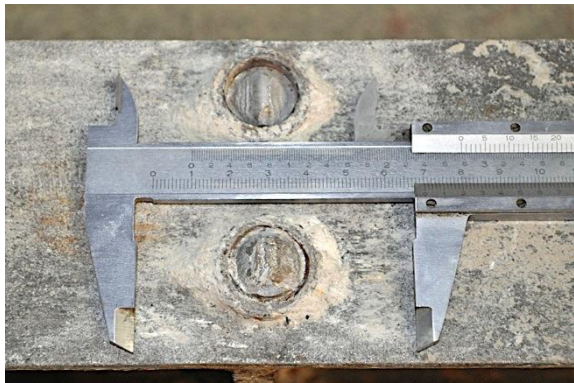
e) Detalle pernos tras rotura
