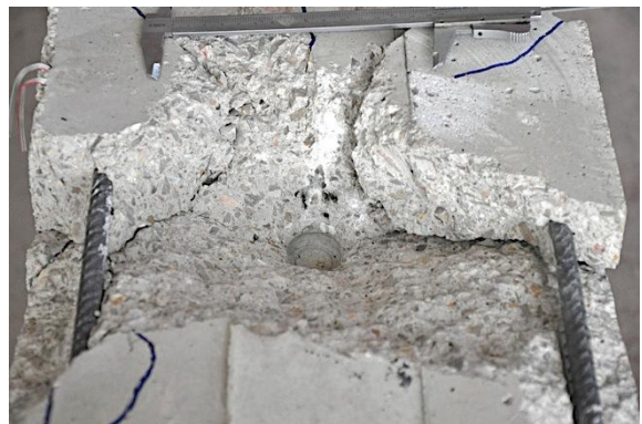
h) Detalle perno tras rotura
