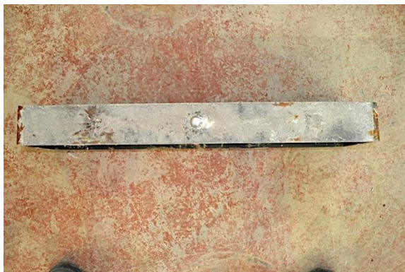
c) Detalle IPE tras rotura
