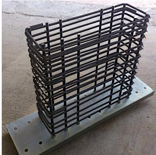
Figura 64. Ejemplo de un armado transversal montado sobre el armado longitudinal.
