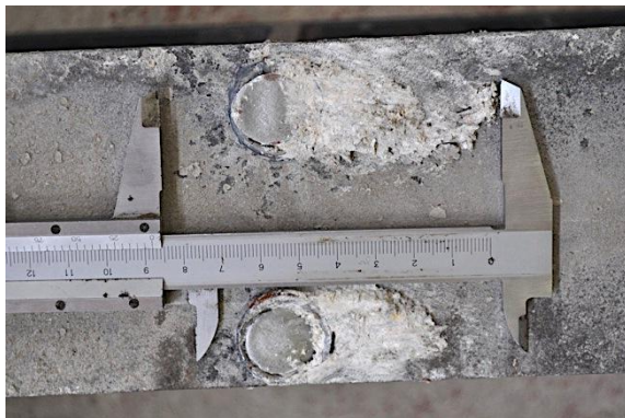
e) Detalle pernos tras rotura
