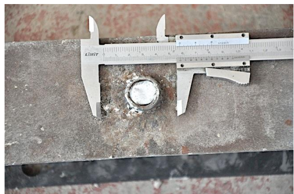
f) Detalle perno derecho tras rotura
