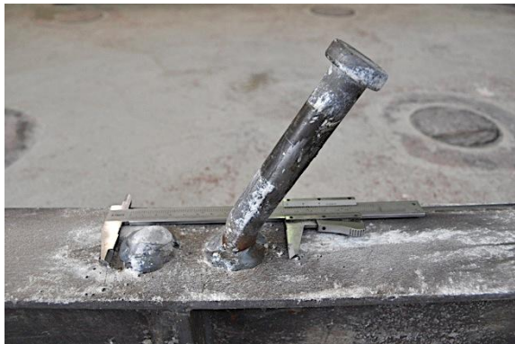
e) Detalle pernos tras rotura
