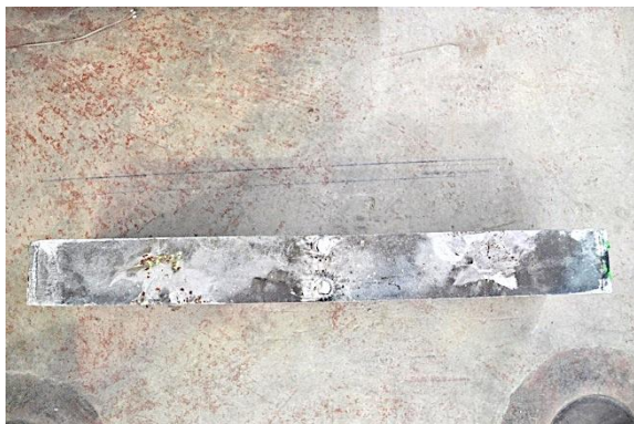
c) Detalle IPE tras rotura
