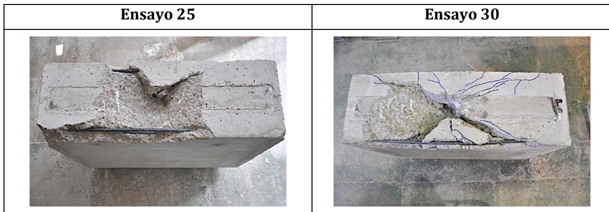
Figura 119. Roturas por pryout de ensayos cíclicos en la disposición POEG.
