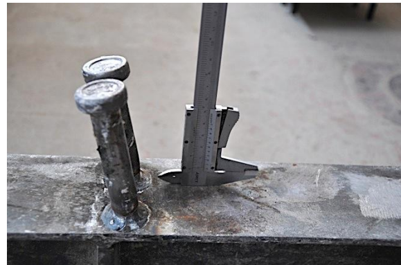
f) Detalle pernos tras rotura
