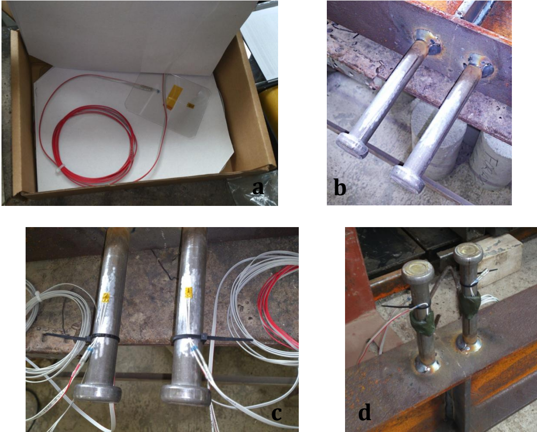
Figura 72. Galga extensiométrica HBM (a), limado de asperezas (b), colocación de las galgas extensiométricas (c), colocación de la masilla de protección (d).
