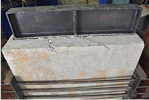
a) Detalle en rotura
