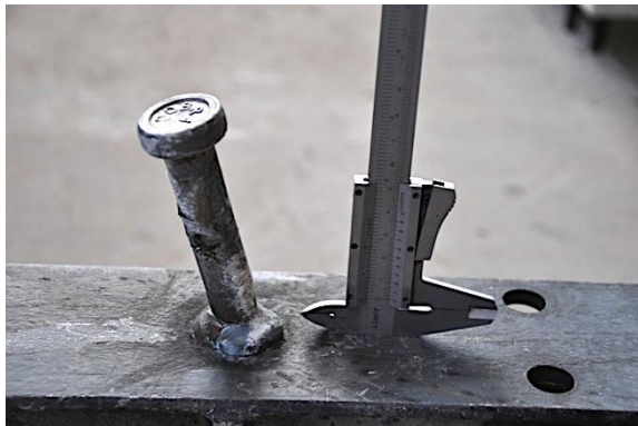
e) Detalle perno tras rotura
