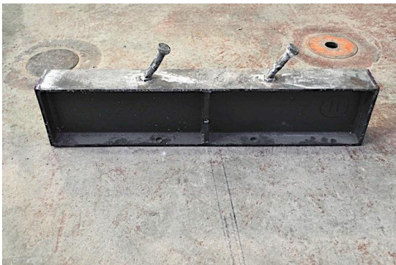
c) Detalle IPE tras rotura
