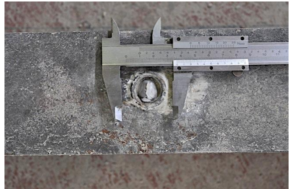
f) Detalle perno derecho tras rotura
