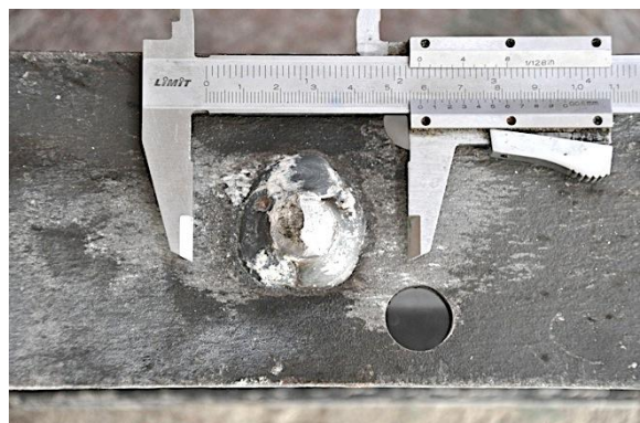
f) Detalle perno derecho tras rotura
