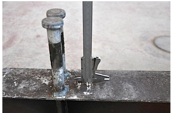
f) Detalle pernos tras rotura
