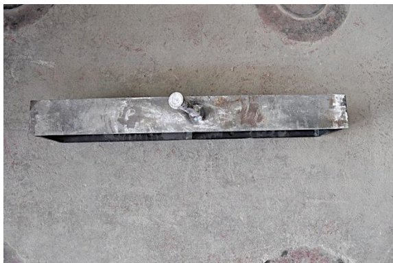
c) Detalle IPE tras rotura
