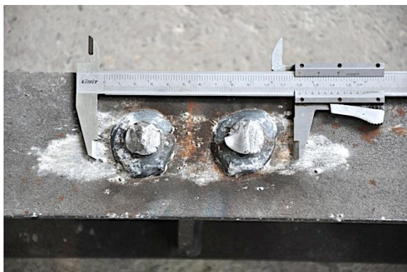
e) Detalle pernos tras rotura
