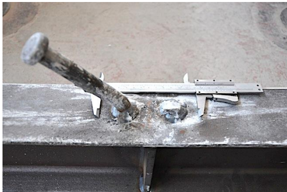
e) Detalle pernos tras rotura
