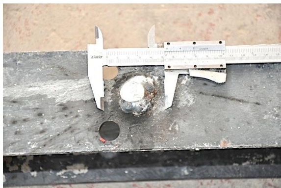
e) Detalle perno izquierdo tras rotura
