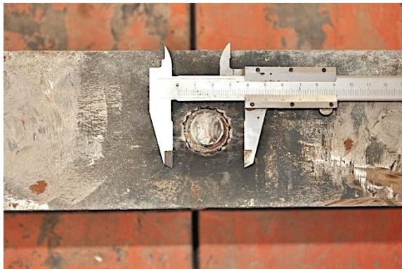
e) Detalle perno tras rotura
