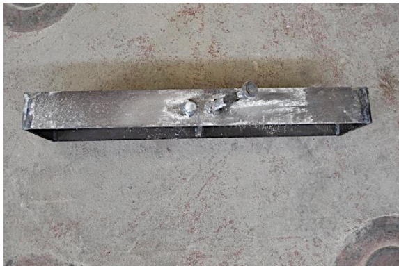
c) Detalle IPE tras rotura
