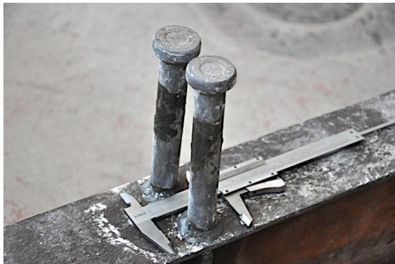
e) Detalle pernos tras rotura
