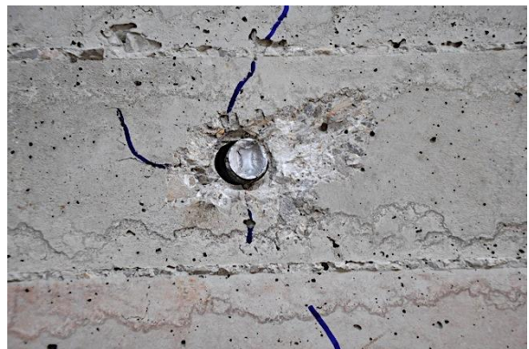
h) Detalle perno derecho tras rotura
