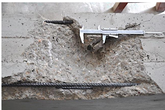
g) Detalle pernos tras rotura
