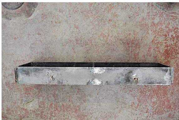
c) Detalle IPE tras rotura
