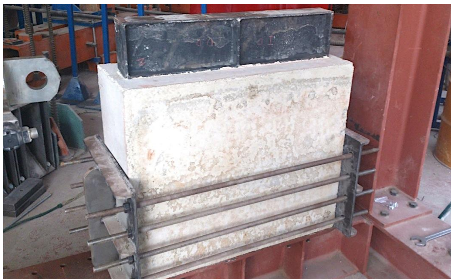
Figura 82. Montaje de la probeta en el pórtico de ensayo paso 3.
