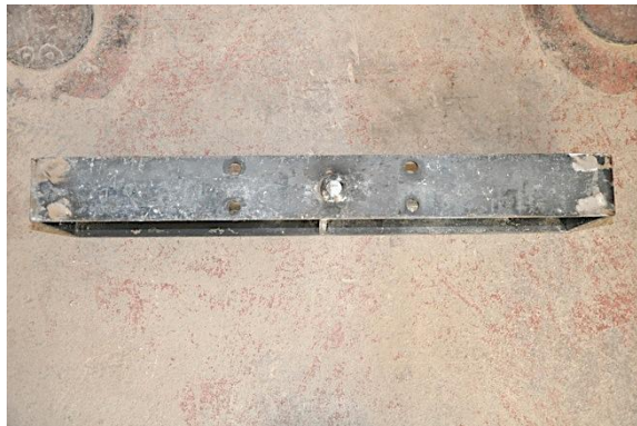
c) Detalle IPE tras rotura
