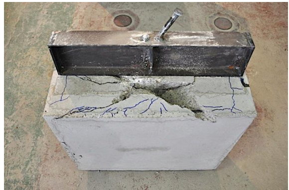
d) Alzado probeta tras rotura
