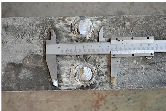
e) Detalle pernos tras rotura
