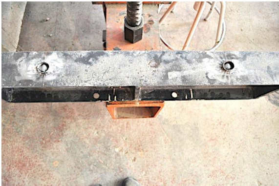
c) Detalle IPE tras rotura
