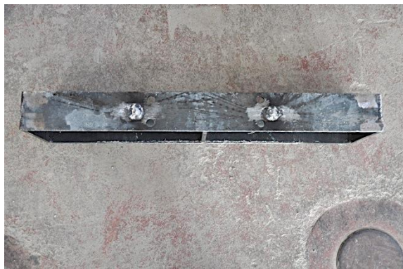
c) Detalle IPE tras rotura
