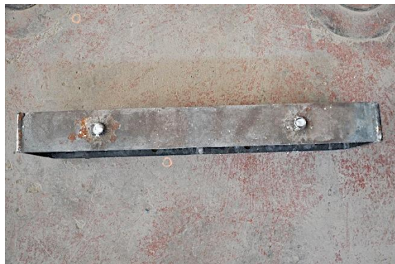
c) Detalle IPE tras rotura
