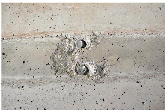
g) Detalle pernos tras rotura
