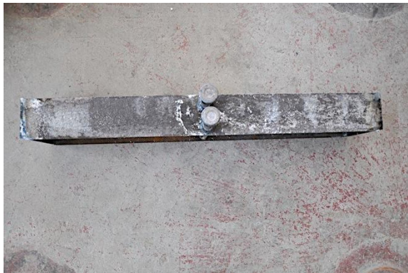
c) Detalle IPE tras rotura
