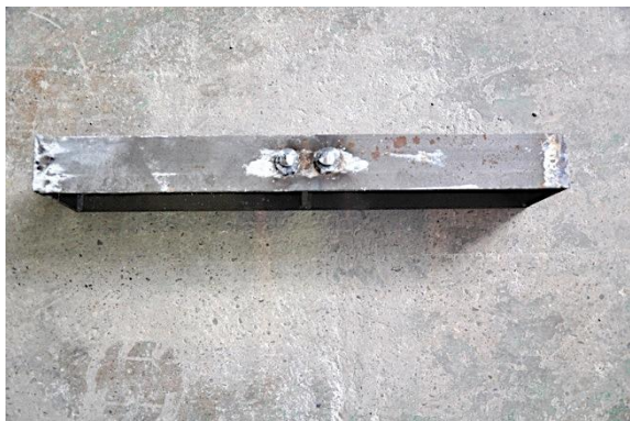
c) Detalle IPE tras rotura
