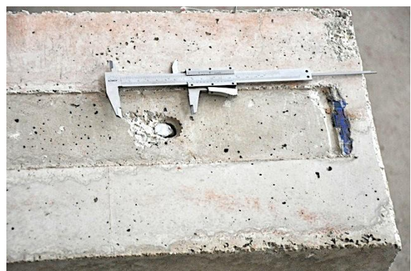
h) Detalle perno derecho tras rotura
