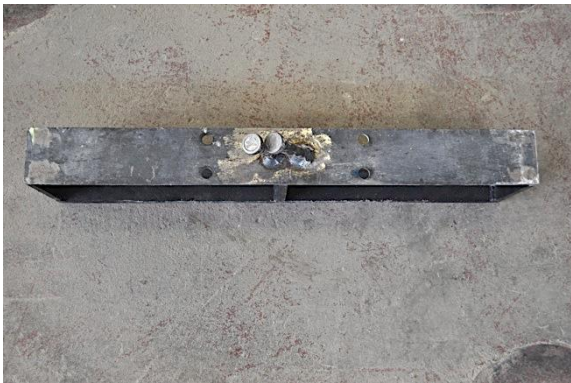
c) Detalle IPE tras rotura
