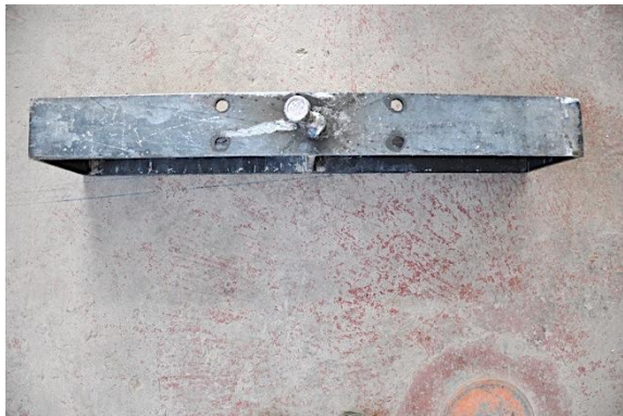
c) Detalle IPE tras rotura
