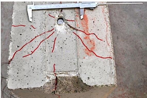
g) Detalle perno izquierdo tras rotura
