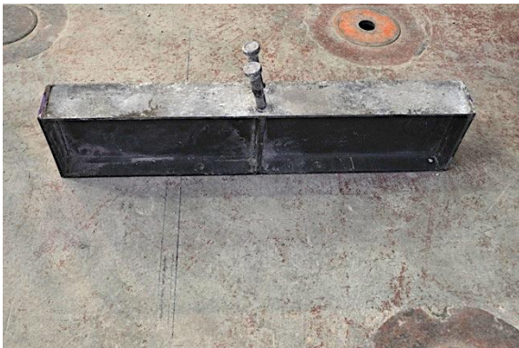
c) Detalle IPE tras rotura
