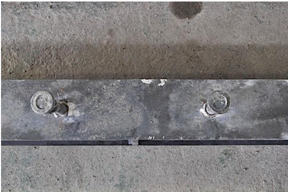
c) Detalle IPE tras rotura
