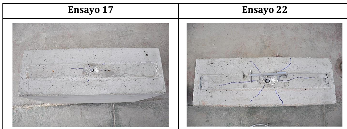
Figura 93. Roturas del acero de ensayos cíclicos en la disposición PI.
