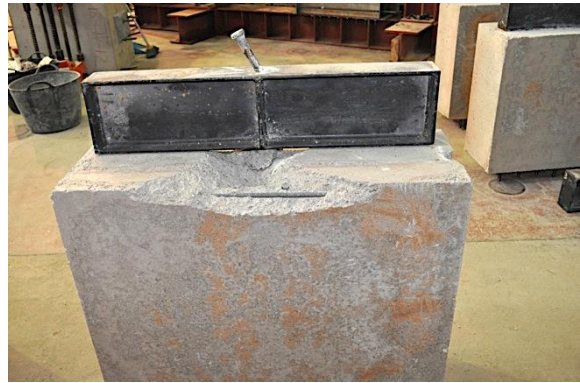
f) Alzado probeta tras rotura
