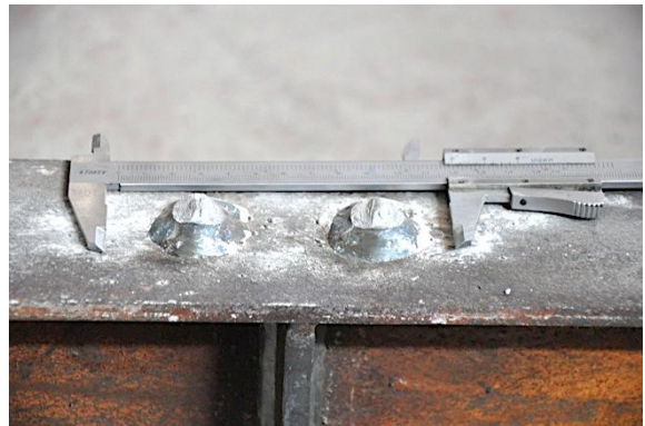
e) Detalle pernos tras rotura
