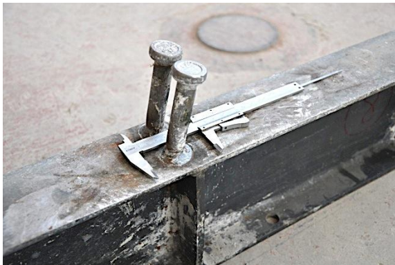
e) Detalle pernos tras rotura
