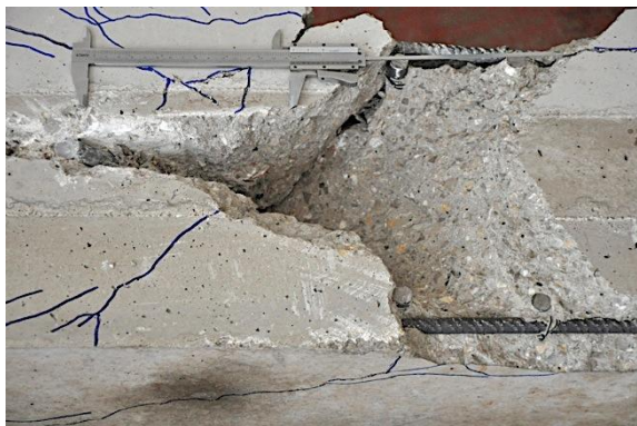
g) Detalle pernos tras rotura
