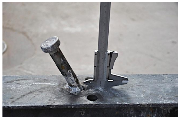
f) Detalle perno derecho tras rotura
