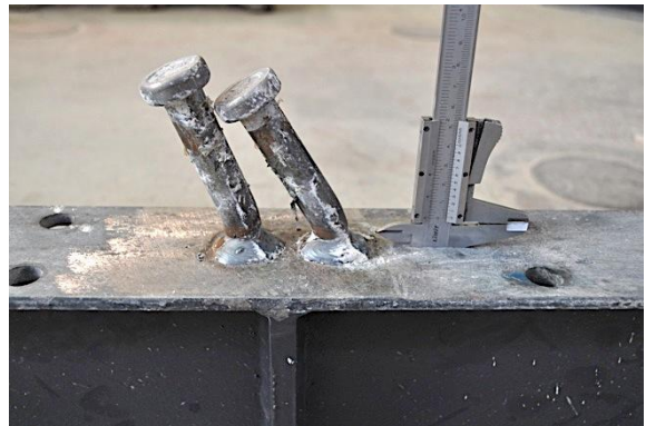
f) Alzado probeta tras rotura
