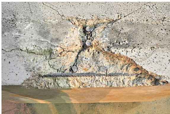
g) Detalle pernos tras rotura
