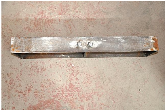
c) Detalle IPE tras rotura
