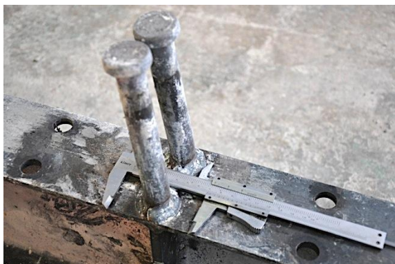
e) Detalle pernos tras rotura
