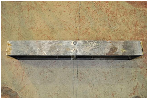
c) Detalle IPE tras rotura
