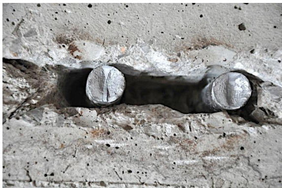
g) Detalle pernos tras rotura
