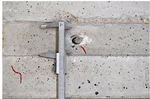
h) Detalle perno derecho tras rotura
