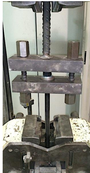
Figura 71. Ensayo a tracción de una barra roscada pavonada de 16 mm de diámetro.
