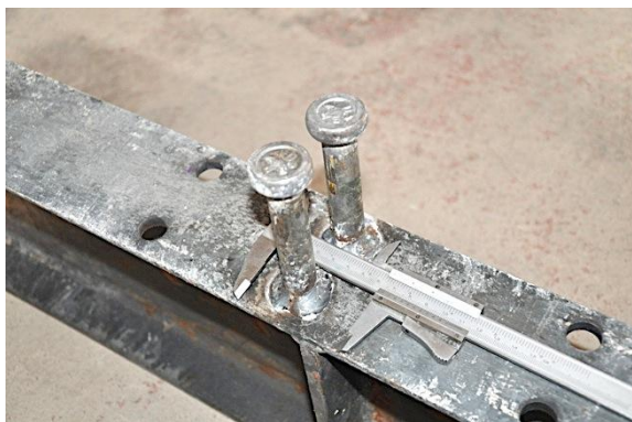
e) Detalle pernos tras rotura
