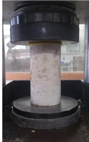
Figura 66. Ensayo de resistencia a compresión de una probeta de acompañamiento.
