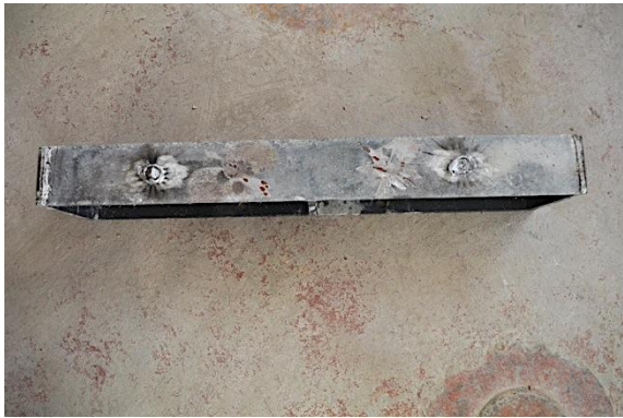
c) Detalle IPE tras rotura
