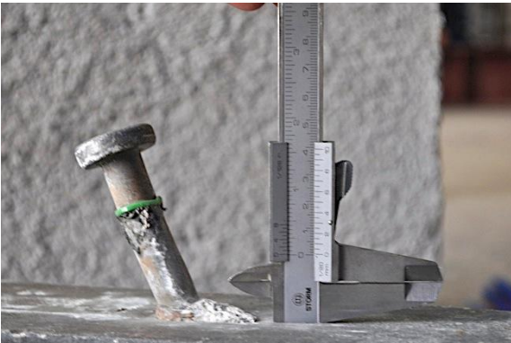
e) Alzado perno izquierdo tras rotura
