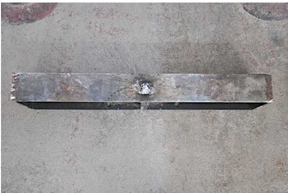
c) Detalle IPE tras rotura
