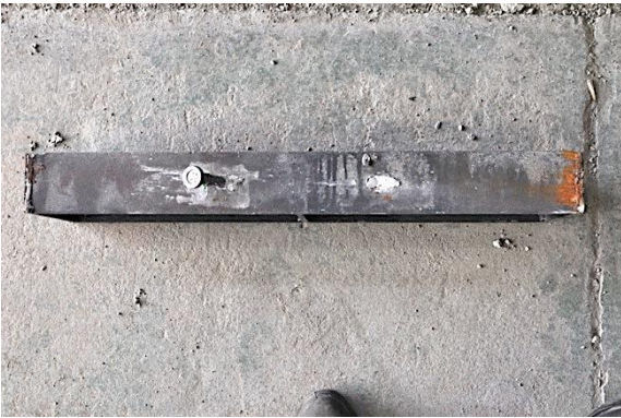
c) Detalle IPE tras rotura
