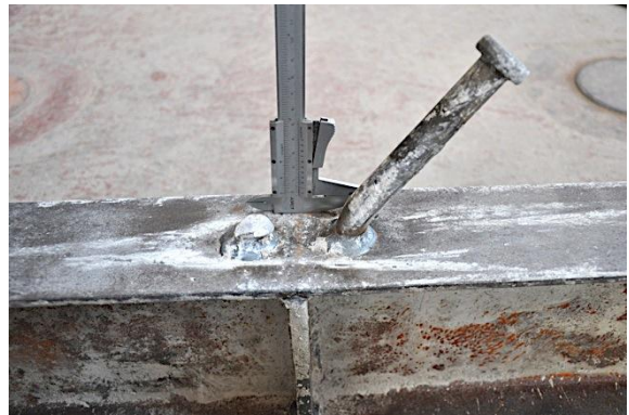
f) Detalle pernos tras rotura
