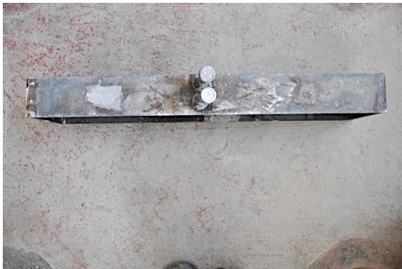
c) Detalle IPE tras rotura
