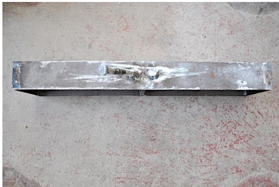
c) Detalle IPE tras rotura
