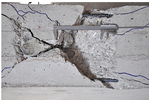
g) Detalle pernos tras rotura
