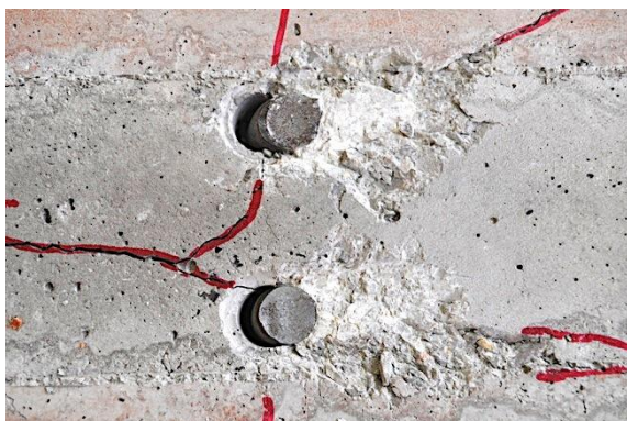
g) Detalle pernos tras rotura
