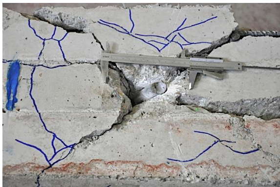
g) Detalle perno izquierdo tras rotura
