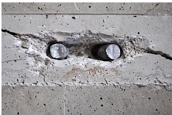
g) Detalle pernos tras rotura
