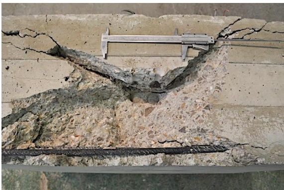
g) Detalle pernos tras rotura
