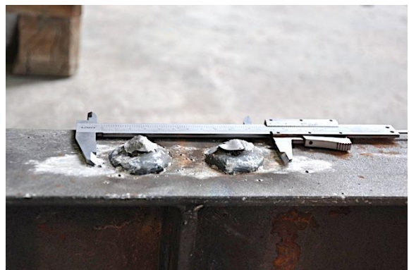
f) Detalle pernos tras rotura
